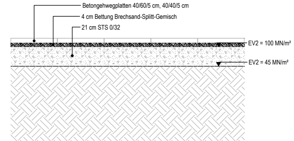
Regelaufbau, Betonplattenbeläge Oberbau Betonplattenweg TL Pflaster-StB
